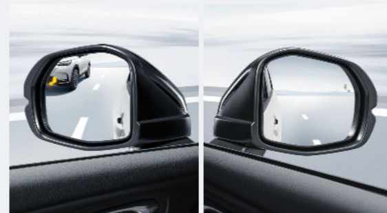
Blind Spot Information (BSI) ระบบช่วยเตือนมุมอับสายตาที่กระจกมองข้าง
