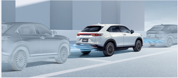
8-Position Parking Sensors เซนเซอร์ระยะระยะ 8 จุด
