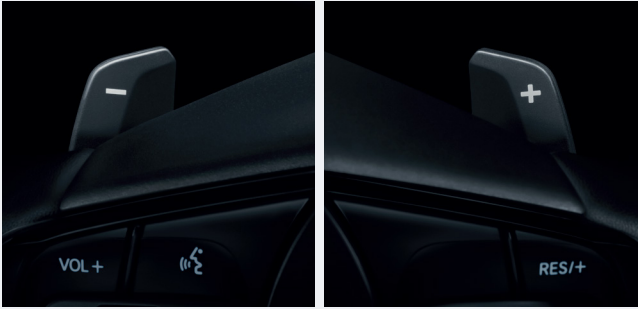
Deceleration Paddle Selectors ระบบช่วยชะลอความเร็วรถที่พวงมาลัย
