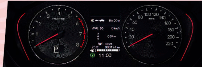
มาตรวัดพร้อมหน้าจอแสดงข้อมูลการขับขี่แบบ TFT ขนาด 4.2 นิ้ว
