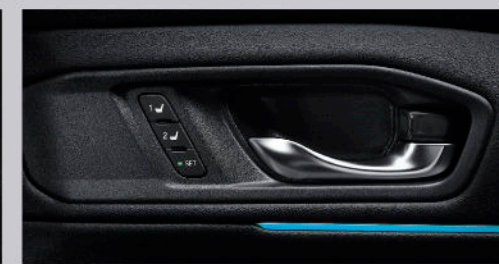
Memory Seat with Easy Entry / Exit ระบบบันทึกตำแหน่งเบาะนั่งของผู้ขับขี่ พร้อมเลื่อนอัตโนมัติเวลาขึ้น-ลงรถ
