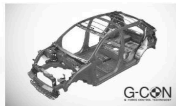
โครงสร้างตัวถังเสริม G-CON และ ACE™ ปกป้องห้องโดยสารจากการชนรอบทิศทาง
