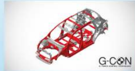
โครงสร้างตัวถังนิรภัย G-CON และ ACE™ ปกป้องห้องโดยสารจากการชนรอบทิศทาง
