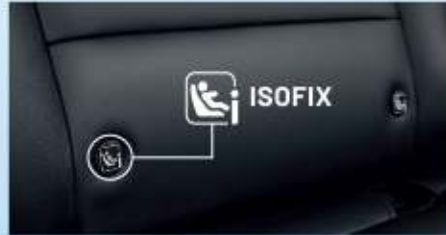
ISOFIX & Child Anchor จุดยึดเกาะเบาะสำหรับเด็ก
